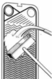
в том, что используемый раствор, его концентрация и температура не вызывают коррозии пластин. При использовании очистки струей под давлением струя должна направляться на пластины вертикально, чтобы избежать повреждения уплотнений. По окончании очистки необходимо смонтировать изъятые уплотнения обратно на пластины. При этом необходимо следить за тем, чтобы между уплотнением и пластиной не попала грязь.
