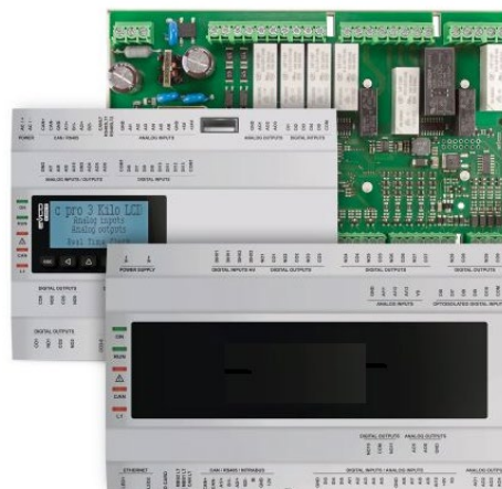
Рисунок – 4. Внешний вид ПЛК и панели оператора
