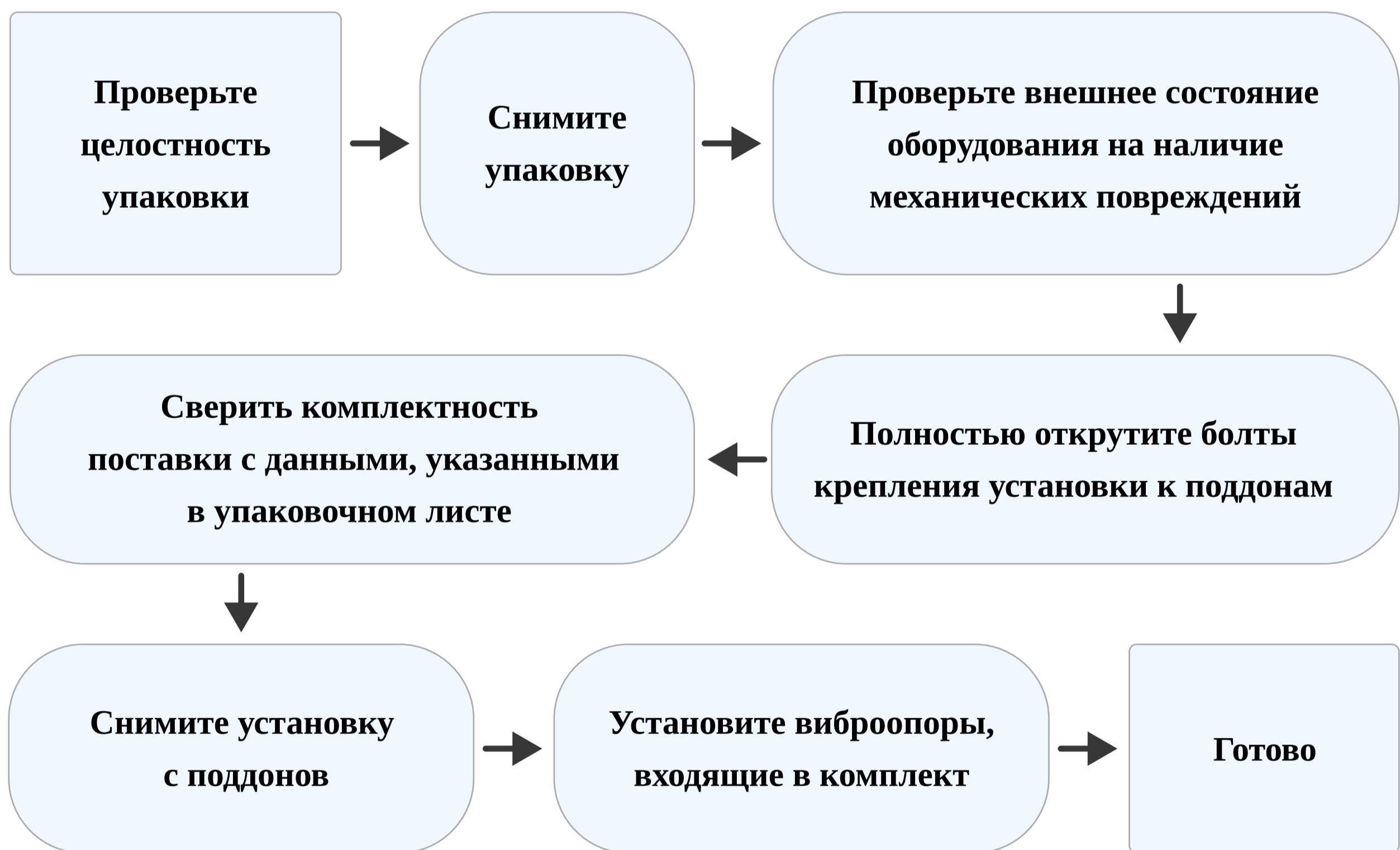
Рисунок – 8. Блок-схема последовательность действий при распаковке НУ
