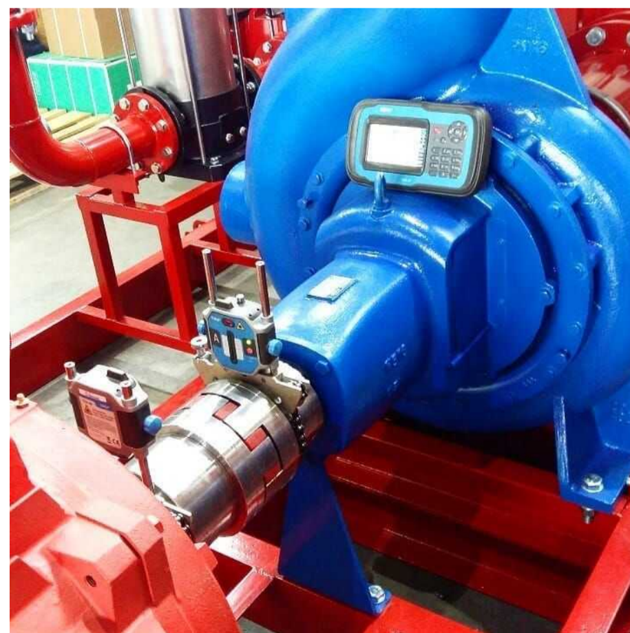
Рисунок – 12. Процесс юстировки консольных насосов
